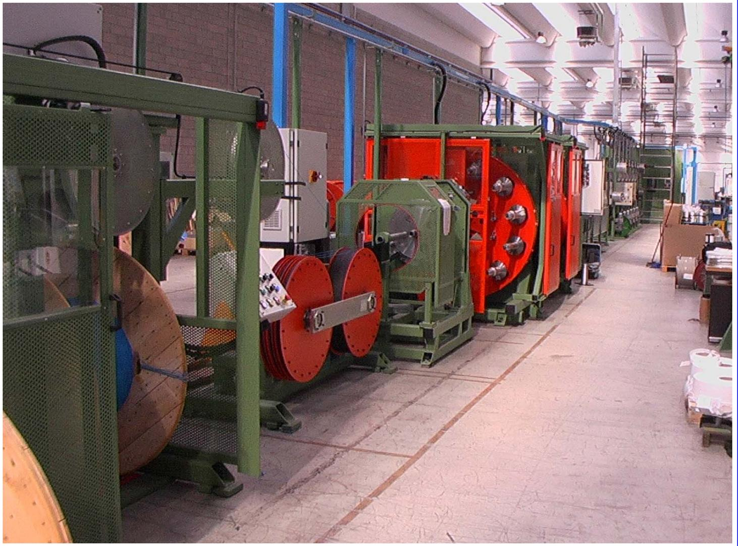
Линия предназначена для скрутки с переменным S-Z шагом оптоволоконных кабелей, состоящих из неплотной трубки или плотного волокна.
